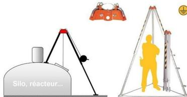
Le trépied de sauvetage pour conditions extrêmes dispose de pieds télescopiques réglables sur 9 niveaux jusqu'à 2,89m, permettant de compenser la hauteur des ouvrages jusqu'à 1,30m.
