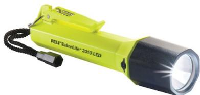
La lampe à main 2010 - PELI est munie d'un joint torique, une lentille à interrupteur rotatif et un socle de protection de polarité empêchant le dégagement d'hydrogène en cas d'inversion accidentelle des piles. Le puissant faisceau de lumière blanche permet au professionnel de travailler efficacement. Le clip et la cordelette permettent d'accrocher la lampe à une ceinture ou une poche.
