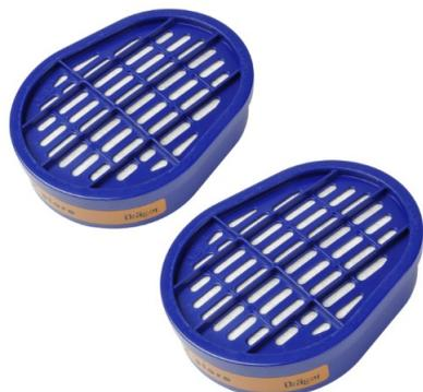
Les filtres ABEK1 X-plore Dräger de classe 1 (faible capacité : concentration des polluants inférieure à 0.1 vol.%) protègent les voies respiratoires des gaz et vapeurs organiques (à point d'ébullition supérieur ou égal à 65°C), inorganiques, acides et de l'ammoniac. Ces filtres masque à gaz xplore à baïonnette s'installent sur les appareils de protection respiratoire suivants : les demi-masques Xplore 3300 et 3500 et sur le masque complet 5500 Dräger.
