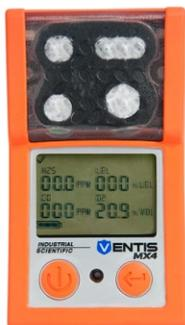
Le détecteur MX4-Ventis peut détecter 1 à 4 gaz parmi les gaz explosifs (LIE), oxygène (O2), monoxyde de carbone (CO), hydrogène sulfuré (H2S), dioxyde de soufre (SO2) et dioxyde d'azote (NO2). Equipé de 3 alarmes, il alerte l'utilisateur rapidement dans les endroits bruyants et/ou sombres.
