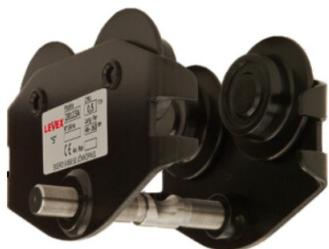
L'utilisation d'un axe central vissé permet un gain important en hauteur perdue par rapport à d'autres chariots. Ses galets en fer forgé à aiguilles assurent un fonctionnement efficace et silencieux. L'antichute de charge est garanti 12 mois et est livré avec son certificat et mode d'emploi. Il se décline en 2 modèles pour chaque capacité permettent un montage sur n'importe quelle largeur et type de fer.
