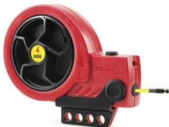
Le dispositif de consignation avec câble rétractable Master Lock S866 permet de condamner simultanément plusieurs cadenas de consignation. On passe le câble dans plusieurs disjoncteurs que l'on ferme avec un cadenas pour empêcher la mise en route accidentelle du courant. Ce matériel de consignation électrique respecte la norme C18-510 relative à la procédure de consignation.
