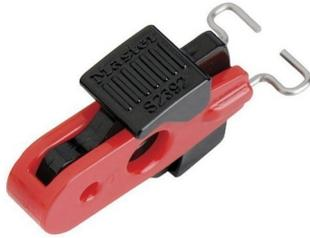
Le bloque disjoncteur miniature Master Lock S2392 consigne la plupart des disjoncteurs miniatures ISO/DIN. Il s'adapte aux disjoncteurs munis de trous de consignation à l'extérieur de l'interrupteur et aux ouvertures jusqu'à 12.7 mm. Les tiges métalliques sont orientées vers l'intérieur. Ce dispositif de consignation de disjoncteur assure la protection contre toute manipulation non autorisée ou accidentelle.
