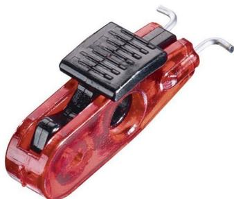
Le Master Lock S2390 se place sur un disjoncteur à maneton de moins de 11mm et est compatible avec la plupart des disjoncteurs miniatures ISO/DIN. On y fixe le cadenas de consignation pour bloquer complètement le disjoncteur. Ce dispositif de consignation de disjoncteur est un accessoire central de la consignation électrique qui permet de neutraliser le courant lors de la maintenance.
