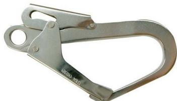
Le mousqueton en acier à verrou automatique est conçu idéalement pour les travaux en hauteur avec risques de chute verticale. Ce mousqueton de travail en hauteur s'ouvre jusqu'à 50mm et possède une poignée de déverrouillage. Ce connecteur peut être connecté à des structures métalliques ou aux câbles, barreaux d'un certain diamètre.
