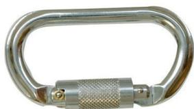
Le mousqueton à verrouillage automatique par bague tournante convient aux travaux en hauteur avec risques de chute verticale. Ce connecteur à fermoir automatique et verrouillage par bague 1/4 de tour est utilisé comme composant d'un système antichute, relié directement ou indirectement à un point d'ancrage. Ce connecteur multi-usage s'ouvre jusqu'à 18mm. Ce mousqueton de travail en hauteur est aussi composé d'un alliage aluminium et respecte la norme EN362:2004 Classe B.
