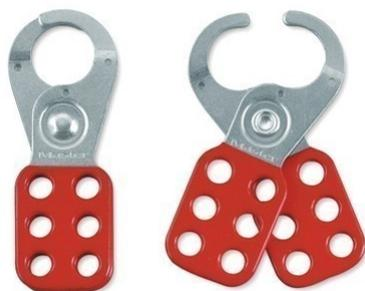
Le morillon 6 cadenas Master Lock 421 permet la condamnation simultanée de plusieurs agents sur le même point de consignation grâce à sa capacité d'accueil de 6 cadenas. L'équipement ne peut être réactivé qu'une fois l'ensemble des cadenas retirés. Ce morillon de consignation maintient l'équipement hors d'usage durant toute la durée des opérations de réparation ou de maintenance.
