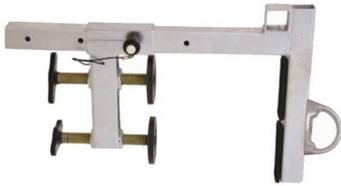
Le point ancrage parapet est spécialement conçu pour les murs de parapets bas, de 60 à 360 mm de large. Sûre et simple d'utilisation, son installation ne nécessite aucun outil et est prévue pour ne pas endommager pas la structure d'accueil. Ce point d'ancrage est utilisable par une personne à la fois et supporte jusqu'à 140 kg maximum. L'ancrage mobile peut être installée sur ce dispositif de sécurité. L'installation de la barre d'ancrage est simple et facile, car elle ne nécessite aucun outil.
