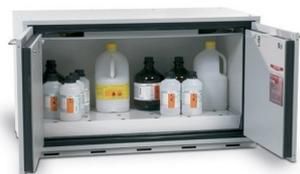
L'armoire sous paille résistant 90 mn au feu est disponible avec tiroir ou portes battantes (nous consulter). Cette armoire anti feu a un corps extérieur en acier ainsi qu'un revêtement intérieur résistant aux produits chimiques. Elle possède une serrure de sécurité et un raccord de diam. 75 mm sur la paroi arrière pour la connexion d'un système de ventilation qui est fortement conseillé (réf. AR0268.01). Le tiroir et les portes peuvent être immobilisés dans toutes les positions.
